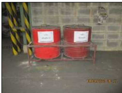
ภาพที่ 2.11 ถังเก็บน้ำมันเสื่อมสภาพหรือน้ำมันหล่อลื่นที่ใช้แล้วจากงานซ่อมบำรุงเครื่องจักรที่เสื่อมสภาพ
